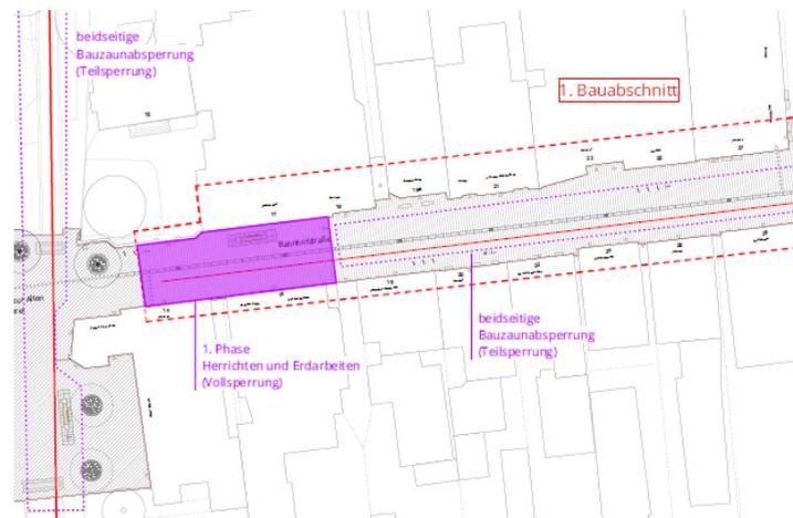
Während der Arbeiten ist eine Fahrgasse außerhalb des Baufeldes für den Ab- und Antransport von Baumaterialien vorgesehen. Diese wird seitlich durch Absperrungen kenntlich gemacht.
